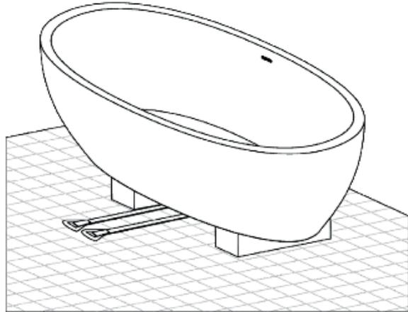
**5. Соедините сифон ванны с центральной канализационной трубой. Проведите проверку на протечки.**
