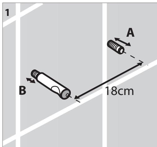
**2** Predisporre il raccordo per lo scarico della cassetta secondo la misura riportata nel particolare ingrandito. Montare il raccordo di scarico sul sanitario e tagliarlo secondo la misura riportata nell'illustrazione. A questo punto posizionare il pezzo sui perni in acciaio e spingerlo fino a parete facendo attenzione che tutti i raccordi si innestino perfettamente (attenzione per agevolare l'innesto si consiglia di lubrificare entrambe le parti).
