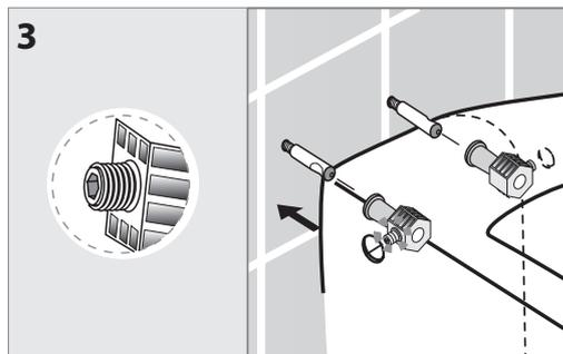
**4** Serrare il grano con la chiave fornita nel kit avendo l'accortezza di tenere il sanitario ben accostato alla parete. Si consiglia di avvitare i fissaggi un po' alla volta alternando l'azione su entrambi fino al completo bloccaggio del pezzo.
