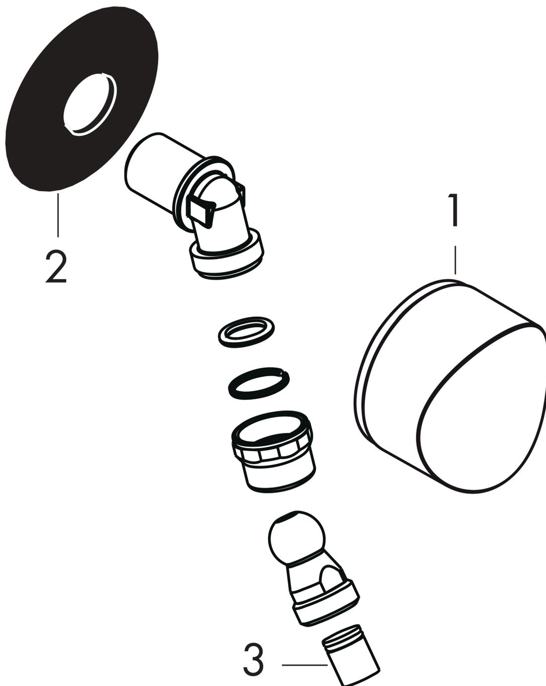
**FixFit****Шланговое подсоединение S с клапаном обратного тока и шарнирным соединением**Поверхность: **Хромированный**    Артикульный номер: **27506000**
