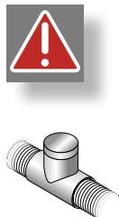
Wanneer de waterinlaat onder de badrand ligt, moet voor de aansluiting een veiligheidssysteem volgens EN 1717 (vloeistofcategorie 5) gebruikt worden. Daarvoor kunt u bijv. een veiligheidsmechanisme DC gebruiken (bijv. buisonderbreker type A 1 met open verbinding naar buiten) dat in de configuratie past. De aansluiting moet door een gekwalificeerde deskundige gemaakt worden.
