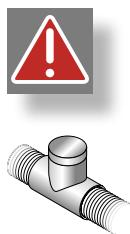
Sobald der Wassereinlauf unterhalb des Wannenrandes liegt, muss der Anschluss mittels einer Sicherheitseinrichtung nach EN 1717 (Flüssigkeitskategorie 5) erfolgen. Das kann z. B. eine Sicherheitseinrichtung DC (z. B. Rohrunterbrecher Typ A 1 mit ständiger Verbindung zur Atmosphäre) unter Berücksichtigung der Einbauanforderungen sein! Der Anschluss ist zwingend durch einen qualifizierten Fachmann vorzunehmen. Dies ist zu berücksichtigen bei:
