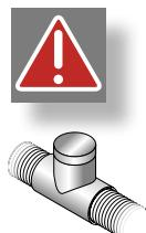
En cuanto la entrada de agua esté por debajo del borde de la bañera, la conexión se debe realizar con un dispositivo de seguridad según EN 1717 (categoría de líquido 5). Puede ser p.ej. un dispositivo de seguridad DC (p.ej. interruptor de tubo Tipo A 1 con conexión permanente con la atmósfera), con consideración de los requisitos de instalación. Es obligatorio que la conexión sea realizada por un técnico autorizado. Esto se debe tener en cuenta para:
