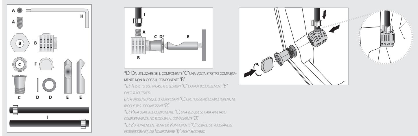
**1** Prédisposer les évacuations et les pivots des étriers en respectant les dimensions indiquées dans les fiches techniques. Découper les pivots filetés selon la dimension indiquée dans le dessin. Visser les deux cylindres en acier jusqu'à la dimension indiquée dans le dessin. ATTENTION : les deux ouvertures doivent être tournées vers le côté d'actionnement du goujon.
