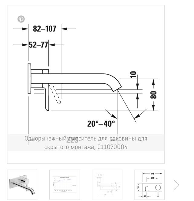
стандартная струя, керамический картридж, регулируемый аэратор, тип соединения: 6азовый комплект для скрытого монтажа, включая: видимые части, рекомендуемое рабочее давление 3-5 бар, излив 225 мм Варианты
