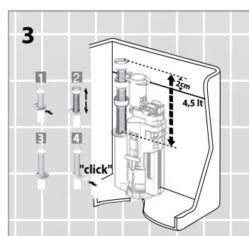
**4** Regolare l'altezza del livello dell'acqua tramite la vite di scorrimento galleggiante come raffigurato, utilizzando i segni di riferimento presenti sulla cassetta (4,5lt).
