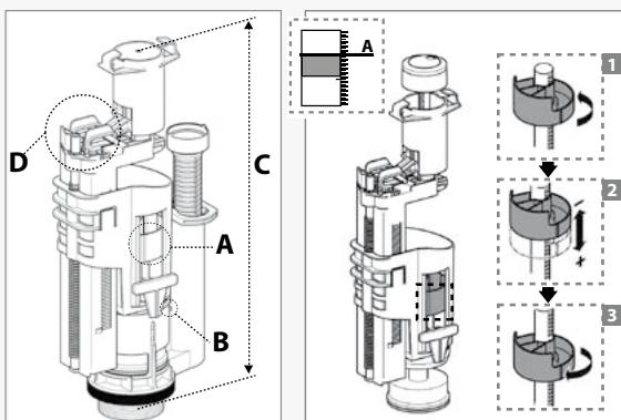
**A** Posizionare il galleggiante (A) per lo scarico parziale nella posizione riportata nel prospetto, a seconda della capacità di scarico scelta.
