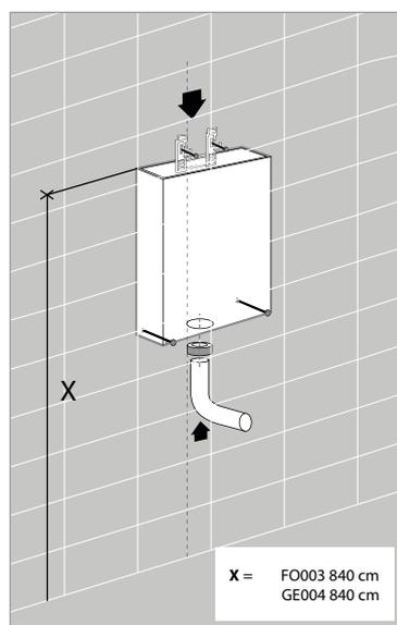
**3\_** Bloccare la cassetta nella parete bassa con le viti e i tasselli forniti in dotazione nel kit. Procedere bloccandola come riportata in figura 3.collegare il tubo di scarico
