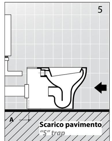
Scarico pavimento "S" trap
