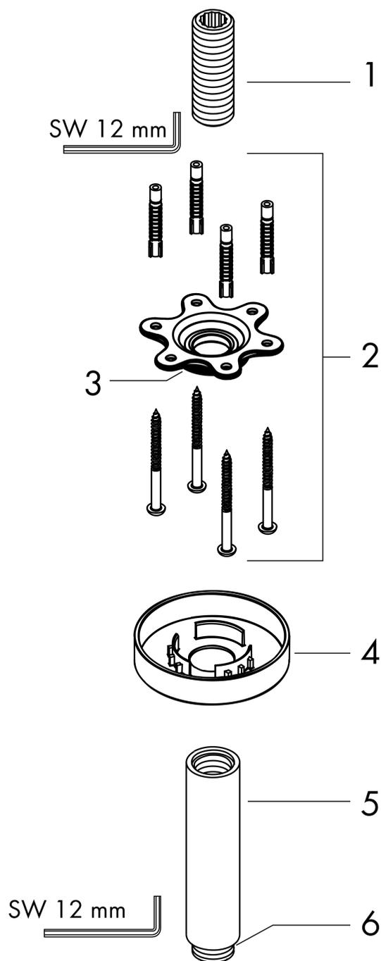
**Потолочное подсоединение S, 100 мм**Поверхность: **Хромированный** Артикульный номер: **27393000**
